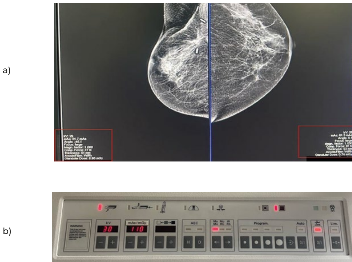
Figura 3. Ejemplo de visualización de parámetros técnicos y Dc: a) en pantalla para mamógrafos digitales directos, b) en consola para mamógrafos digitalizados.
