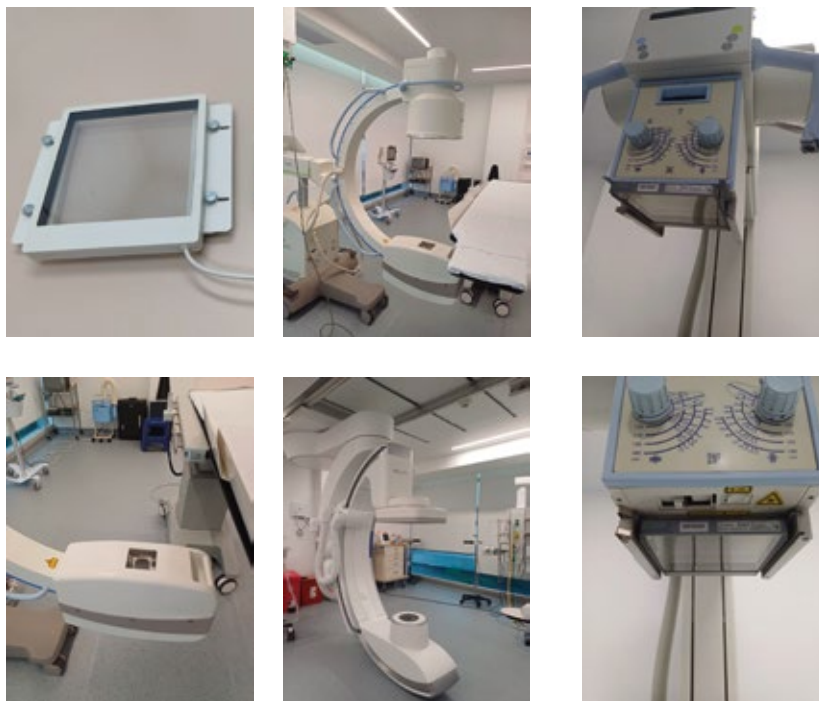
Figura 1. Dispositivos medidores de P_{KA} en equipos de rayos X
